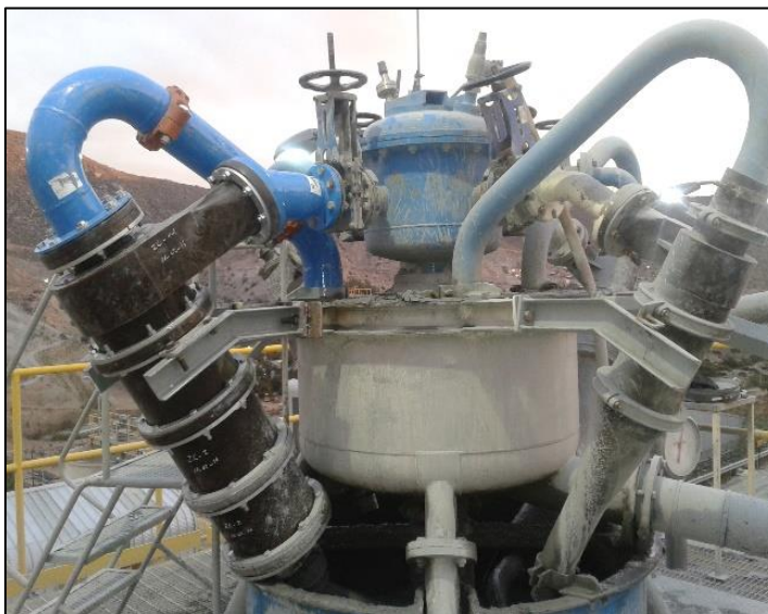
Imagen N°1: Hidrociclones de la línea 1 de molienda
